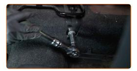
Vuelva a instalar las cubiertas de plástico de los rieles del asiento trasero.
