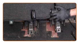
Suelte los retenedores de la cubierta de acceso al módulo de la bomba de combustible. Utilice un destornillador Phillips.
