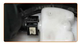
Una el conector del módulo de la bomba de combustible.
