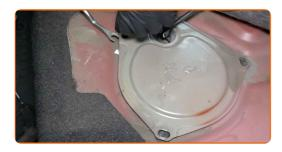
Limpie el asiento de montaje del módulo de la bomba de combustible. Utilice un spray de limpieza multiuso.
