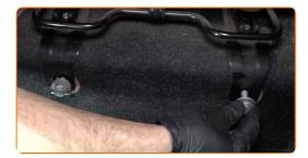
Enrosque las sujeciones delanteras de los rieles del asiento trasero. Use un vaso de impacto del n.º 17. Utilice una llave de trinquete.
