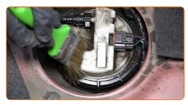
Separe el conector del módulo de la bomba de combustible.
