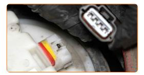
Separe el conducto de combustible del módulo de la bomba de combustible. Utilice alicates para conectores de tubos de combustible.
