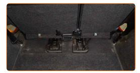
Retire las cubiertas de plástico de los rieles de los asientos traseros. Utilice una herramienta de extracción de clips.
