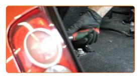
Vuelva a instalar las cubiertas de plástico de los rieles del asiento trasero.
