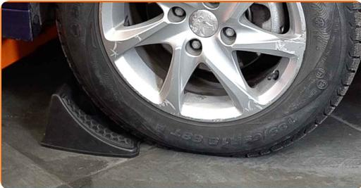
**2** Afloje los pernos de fijación de la rueda. Utilice una llave de impacto para llanta # 21.
