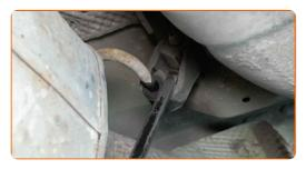
Separe el silenciador del tubo de escape. Use una palanca. Utilice un martillo.
