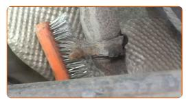
Afloje la abrazadera del silenciador de escape. Use un vaso de impacto del n.º 13. Utilice una llave de trinquete.
