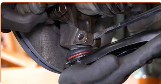
**19** Instale el perno de sujeción.
