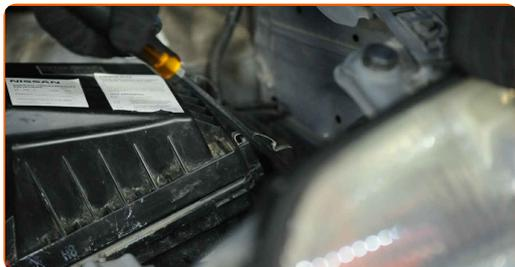
**30** Asegure la sujeción del conducto de admisión de aire. Utilice un destornillador plano.
