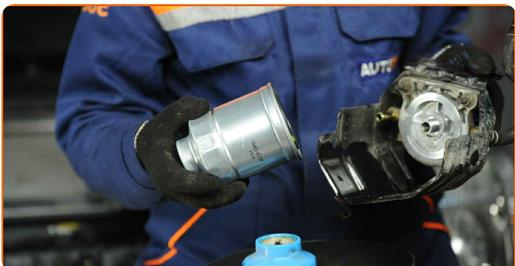
**17** Limpie la carcasa del filtro de combustible y la cubierta. Utilice un spray de limpieza multiuso.
