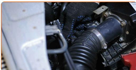
**31** Conecte la manguera de ventilación del cárter al conducto de aire.
