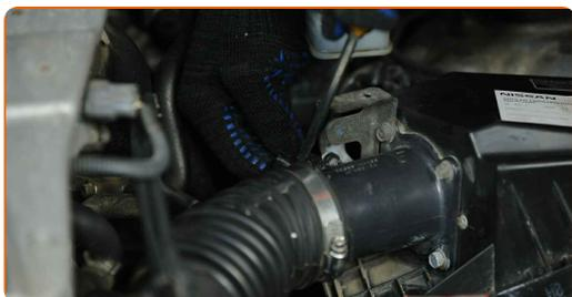
**8** Separe el tubo de vacío. Utilice alicates.
