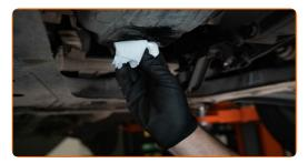
Atornille en el nuevo tapón de drenaje y apriételo. Utilice una llave dinamométrica. Apriételo a un par de 34 Nm.
