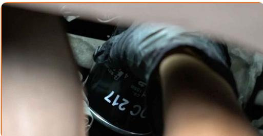
**16** Apriete el filtro de aceite. No se olvide de respetar el par de apriete recomendado. Utilice el vaso 65-14F. Utilice una llave dinamométrica. Apriételo a un par de 18 Nm.
