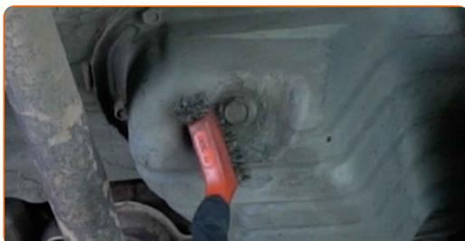
**8** Desenrosque el tapón de drenaje. Use un vaso de impacto del n.º 14. Utilice una llave de trinquete.
