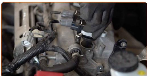
**18** Trate el conector de la bobina de encendido con spray para electrónica. El spray protegerá los contactos eléctricos de la corrosión, oxidación, y reducirá la resistencia de contacto.
