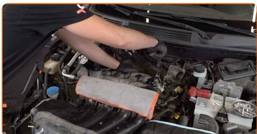
**20** Enchufe el conector de la bobina de encendido.
