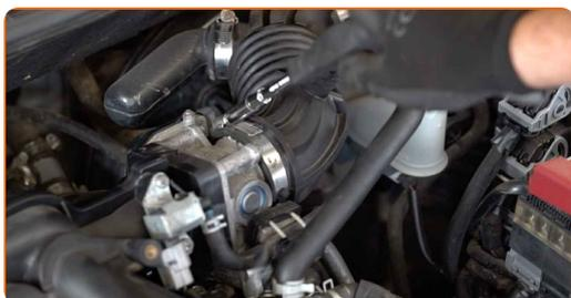
**5** Desconecte el tubo de entrada de aire de la carcasa del filtro de aire.
