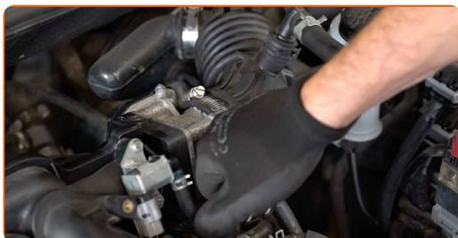
**4** Desatornille las abrazaderas y las sujeciones en el tubo de aspiración del filtro de aire. Use un vaso de impacto del n.º 10. Utilice una llave de trinquete.
