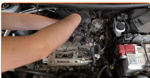
**15** Saque la bobina de ignición del pozo de la bujía.
