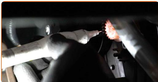
**7** Desenrosque las sujeciones del actuador de la aleta de la calefacción. Usa una llave mixta del n.º 8.
