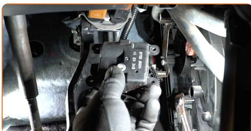
**9** Desenchufe el conector del actuador de la aleta de la calefacción.
