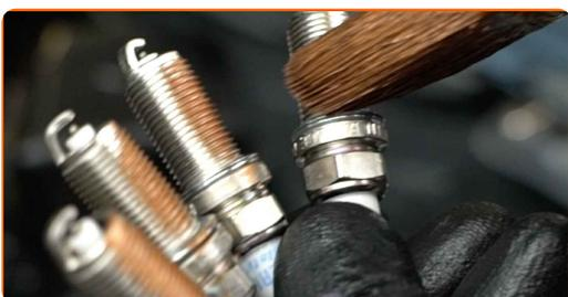
**10** Instale las nuevas bujías en sus asientos de montaje.
