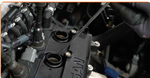
**7** Desenrosque las bujías. Use el vaso de bujía # 16. Utilice una llave de trinquete.
