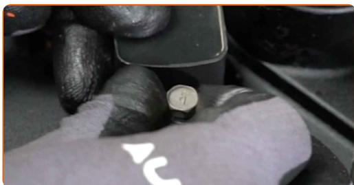
**14** Apriete las sujeciones de la bobina de ignición. Use un vaso de impacto del n.º 10. Utilice una llave dinamométrica. Apriételo a un par de 9 Nm.
