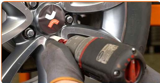
**27** Baje el automóvil y, manteniendo el orden cruzado, apriete los pernos de fijación de las ruedas. Utilice una llave de impacto para llanta # 21. Utilice una llave dinamométrica. Apriételo a un par de 118 Nm.
