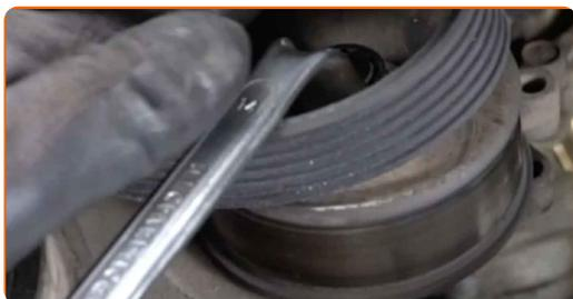
**13** Coloque la correa acanalada en V en la polea tensora.
