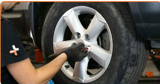
28 Baje el automóvil y, manteniendo el orden cruzado, apriete los pernos de fijación de las ruedas. Utilice una llave dinamométrica. Apriételo a un par de 112 Nm.
