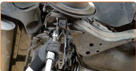
**12** Retire el perno de sujeción. Use un punzón. Utilice un martillo.
