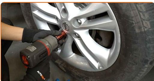
**22** Baje el automóvil y, manteniendo el orden cruzado, apriete los pernos de fijación de las ruedas. Utilice una llave de impacto para llanta # 21. Utilice una llave dinamométrica. Apriételo a un par de 112 Nm.
