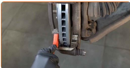
**13** Trate las pastillas de freno en el área donde su superficie entra en contacto con el soporte de la pinza de freno. Use pasta antichirridos.
