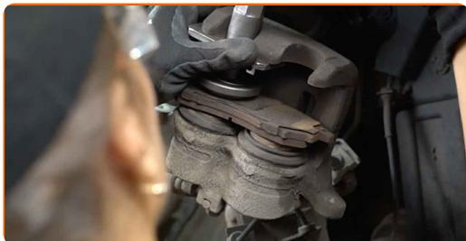
**17** Establezcan el soporte de freno y lo fijen. Usa una llave mixta del n.º 17. Use un vaso de impacto del n.º 14. Utilice una llave dinamométrica. Apriételo a un par de 34 Nm.
