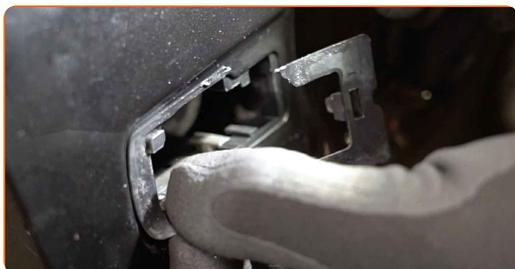
**26** Suelte el actuador de la manija exterior de la puerta. Utilice un destornillador plano.
