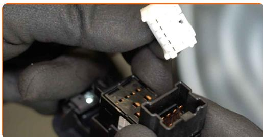
**45** Instale el módulo del interruptor del elevavinas eléctrico.
