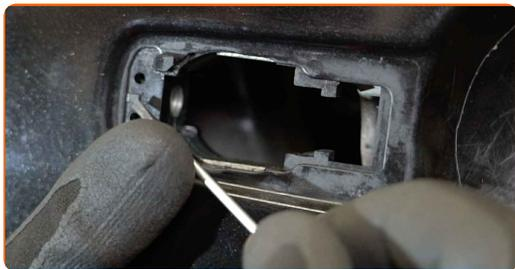
**27** Separe el cable del actuador de la manija exterior de la puerta.
