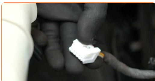
**7** Retire el módulo del interruptor del elevavinas eléctrico.
