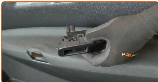
**8** Una el conector del elevavinas eléctrico al módulo del interruptor.
