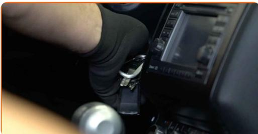
**13** Desensrosque las sujeciones del cristal de la ventana. Use un vaso de impacto del n.º 10. Utilice una llave de trinquete.
