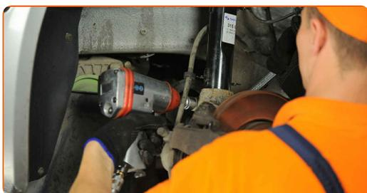
43 Instale la barra del estabilizador de estabilidad transversal.
