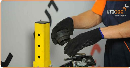
26 Instale el soporte superior nuevo de la pata amortiguadora.
