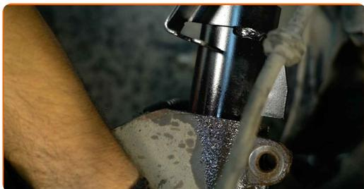
39 Sostenga el muñón de dirección. Utilice un gato de transmisión hidráulica.
