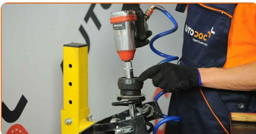
**Sustitución: copelas del amortiguador - Skoda Octavia 1U. Consejo:**
