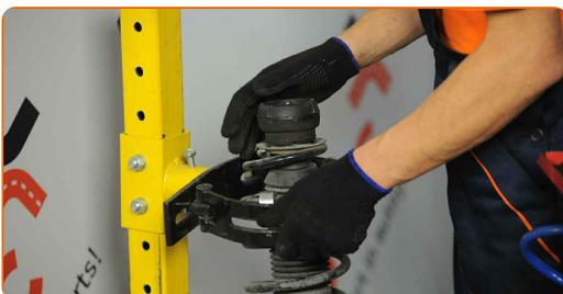
Sustitución: copelas del amortiguador - Skoda Octavia 1U. AUTODOC recomienda:
