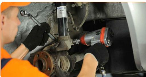
25 Retire el perno de sujeción.
