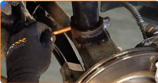
**40** Apriete las sujeciones inferiores del puntal de suspensión. Usa una llave mixta del n.º 18. Use un vaso de impacto del n.º 18. Utilice una llave dinamométrica. Apriételo a un par de 60 Nm.+90°
