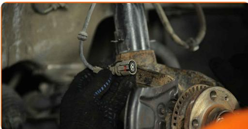
**48** Conecte los cables del captador ABS.
