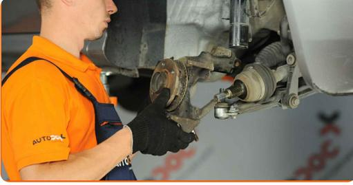
**38** Fije la pata amortiguadora en el muñón de dirección. Utilice un mazo de goma.
