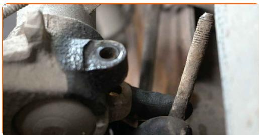
26 Desconecte el muñón de dirección de la pata amortiguadora. Utilice un mazo de goma.
