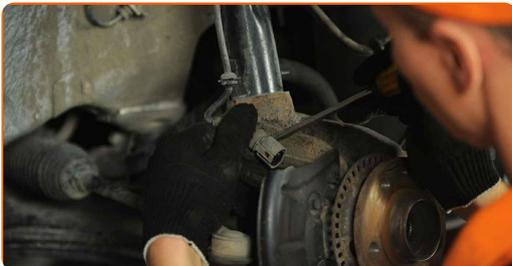
**16** Desconecte el cableado del captador ABS. Utilice un destornillador plano.
