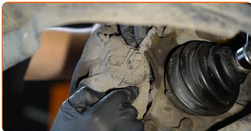
**20** Instale el resorte de fijación del cáliper de freno.
