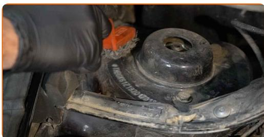
**6** Afloje la sujeción superior del soporte del amortiguador. Use un vaso de impacto del n.º 13. Utilice una llave de trinquete.
