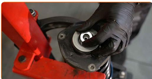
**43** Apriete la tuerca de la varilla de la pata amortiguadora. Use Vaso HEX No. H6. Use un vaso de impacto del n.º 22. Utilice una llave dinamométrica. Apriételo a un par de 60 Nm.
