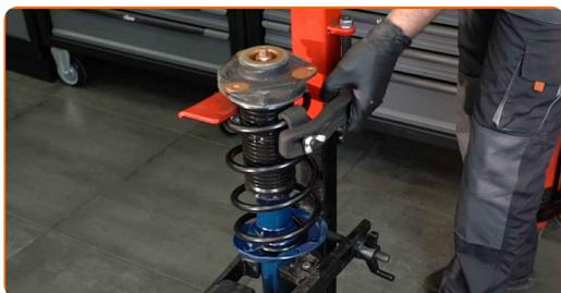
**46** Retire el puntal amortiguador que está montado.
