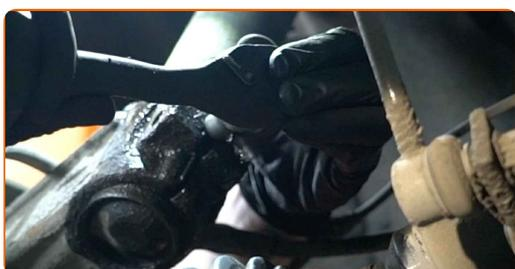
**27** Sostenga el muñón de dirección. Utilice un gato de transmisión hidráulica.
