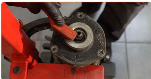
**34** Destornille la tuerca de la varilla de la pata amortiguadora. Use Vaso HEX No. H7. Use un vaso de impacto del n.º 21. Utilice una llave de trinquete.
