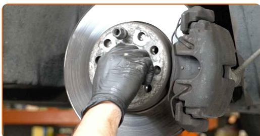
**60** Apriete las sujeciones inferiores que conectan el amortiguador con la mangueta de dirección. Utilice las puntas XZN #14. Use un vaso de impacto del n.º 18. Utilice una llave dinamométrica. Apriételo a un par de 70 Nm.+90°
