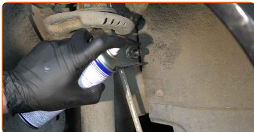
**13** Desatornille la sujeción que conecta la bieleta de barra estabilizadora al amortiguador. Use un vaso de impacto del n.º 18. Utilice una llave de trinquete.
