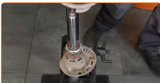
**38** Retire el amortiguador viejo del compresor de muelles hidráulico.
