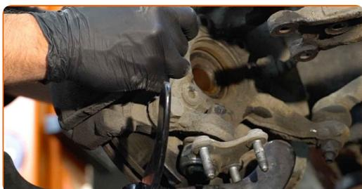
**28** Desconecte el muñón de dirección de la pata amortiguadora.
