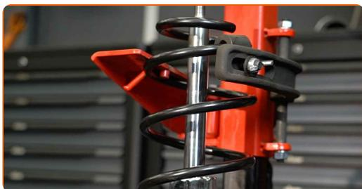
**42** Instale la cazoleta, el guardapolvos y el tope en el amortiguador nuevo.
