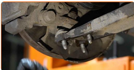
**58** Apriete la fijación del soporte esférico. Use un vaso de impacto del n.º 16. Utilice una llave dinamométrica. Apriételo a un par de 60 Nm.
