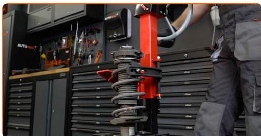
**33** Trate la varilla del amortiguador. Use un cepillo de alambre. Use el aerosol WD-40.
