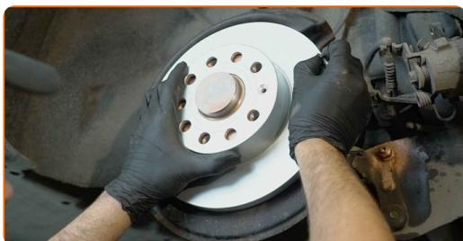
**20** Apriete la fijación del disco de freno. Utilice Torx T30. Utilice una llave dinamométrica. Apriételo a un par de 4 Nm.
