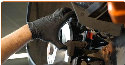
**23** Apriete la fijación de la pinza del cáliper de freno. Utilice las puntas XZN #14. Utilice una llave dinamométrica. Apriételo a un par de 90 Nm.+90°
