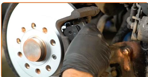
**27** Establezcan el soporte de freno y lo fijen. Usa una llave mixta del n.º 15. Use un vaso de impacto del n.º 13. Utilice una llave dinamométrica. Apriételo a un par de 35 Nm.
