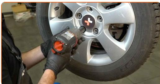
**19** Baje el automóvil y, manteniendo el orden cruzado, apriete los pernos de fijación de las ruedas. Utilice una llave de impacto para llanta # 17. Utilice una llave dinamométrica. Apriételo a un par de 120 Nm.
