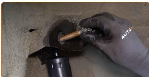
**16** Atornille la sujeción superior del amortiguador. Use un vaso de impacto del n.º E18. Utilice una llave de trinquete.
