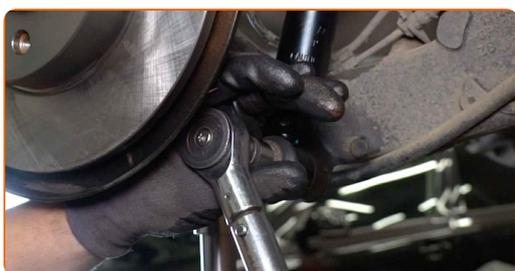
**20** Apriete la fijación superior del amortiguador. Use un vaso de impacto del n.º E18. Utilice una llave dinamométrica. Apriételo a un par de 90 Nm.
