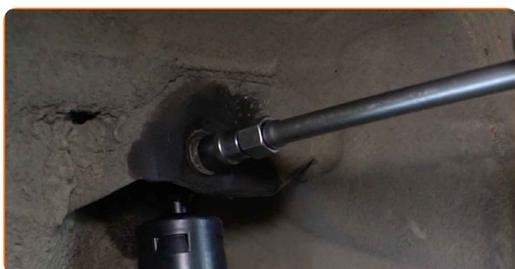
**21** Retire el soporte por debajo de la viga trasera.
