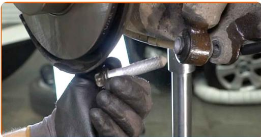
**10** Destornille la fijación superior del amortiguador. Use un vaso de impacto del n.º E18. Utilice una llave giramachos.
