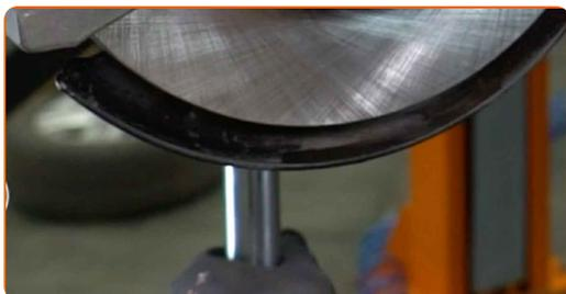
**19** Apriete la fijación inferior del amortiguador. Use un vaso de impacto del n.º E20. Utilice una llave dinamométrica. Apriételo a un par de 130 Nm.
