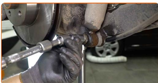
**9** Retire el perno de sujeción.
