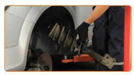
20 Instale la pata amortiguadora en el mecanismo para apretar los resortes.
