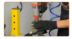
Quite el apoyo superior de la pata. Utilice un destornillador plano.
