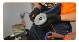
Apriete la tuerca de la varilla de la pata amortiguadora. Use un vaso de impacto del n.º 21. Utilice una llave dinamométrica. Apriételo a un par de 65 Nm.
