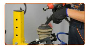
Destornille la tuerca de la varilla de la pata amortiguadora. Use un vaso de impacto del n.º 21. Utilice una llave de trinquete.
