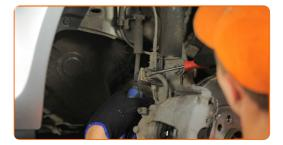
Suelte el conector del sensor ABS. Utilice un destornillador plano.
