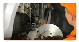
Apriete las sujeciones inferiores que conectan el amortiguador con la mangueta de dirección. Usa una llave mixta del n.º 18. Use un vaso de impacto del n.º 18. Utilice una llave dinamométrica. Apriételo a un par de 85 Nm.+90°
