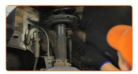
Desatornille la sujeción que conecta la bieleta de barra estabilizadora al amortiguador. Usa una llave mixta del n.º 19. Use Vaso HEX No. H5. Utilice una llave de trinquete.
