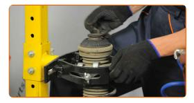
Retire la tapa de soporte del puntal suspensión. Utilice un destornillador plano.
