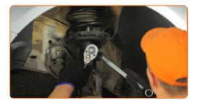
Trate las sujeciones del amortiguador. Trate todas las juntas de la bieleta o enlace estabilizador. Use grasa de cobre.
