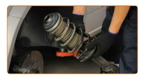
Atornillen la fijación superior de la cazoleta de la pata amortiguadora. Use alicates de bomba de agua.
