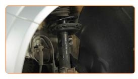
Apriete la sujeción que conecta la bieleta de barra estabilizadora al amortiguador. Usa una llave mixta del n.º 19. Use Vaso HEX No. H5. Utilice una llave dinamométrica. Apriételo a un par de 60 Nm.
