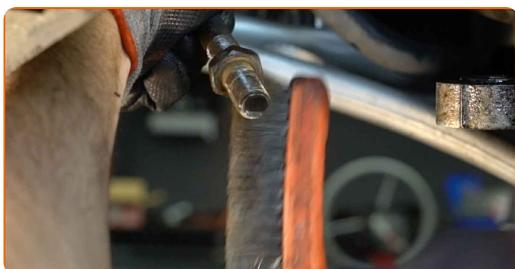
**14** Trate los asientos de montaje del extremo de la barra de acoplamiento. Use grasa de cobre.
