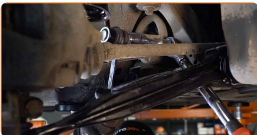
**11.2** Usa una llave mixta del n.º 19. Use un vaso de impacto del n.º 18. Utilice una llave dinamométrica. Apriételo a un par de 65 Nm.
