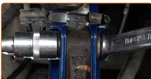
**32** Limpie la sujeción del sensor del ABS. Use un cepillo de alambre. Use el aerosol WD-40.
