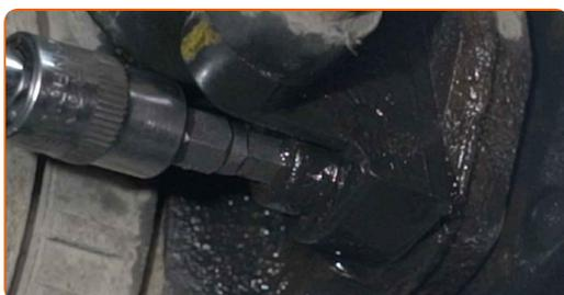
**34** Retire el perno de sujeción.
