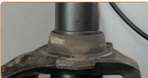
**49** Presione para extraer el aro de rodamiento interior que queda en el cubo. Utilice un separador de rodamientos.
