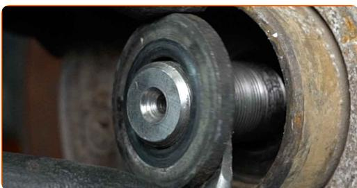
**17** Separe las pastillas de freno. Use una palanca.
