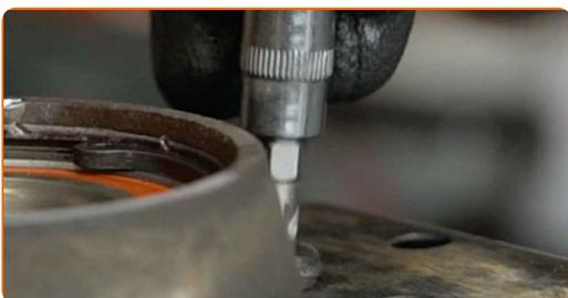
**56** Limpie el asiento de montaje del cubo de rueda. Utilice un spray de limpieza multiuso.
