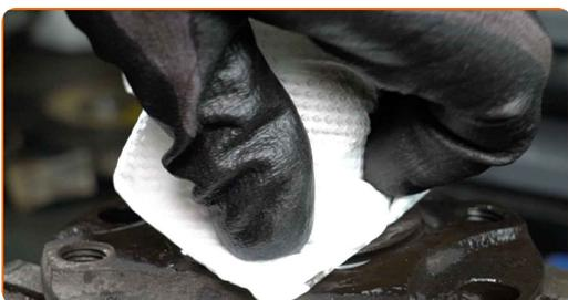
**57** Trate el asiento de montaje del cubo de rueda. Use el aerosol WD-40.
