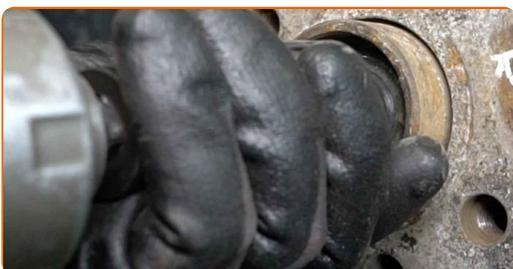
**16** Retire la arandela del rodamiento de la rueda. Use una palanca.
