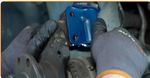
**63** Instale el perno de sujeción.
