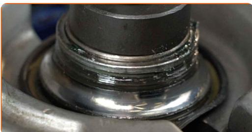
**50** Limpie el asiento de montaje del cojinete del cubo (buje). Use un cepillo de alambre. Use el aerosol WD-40. Utilice un spray de limpieza multiuso.
