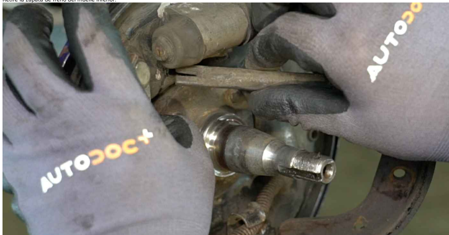
18 Retire la zapata de freno derecha.
