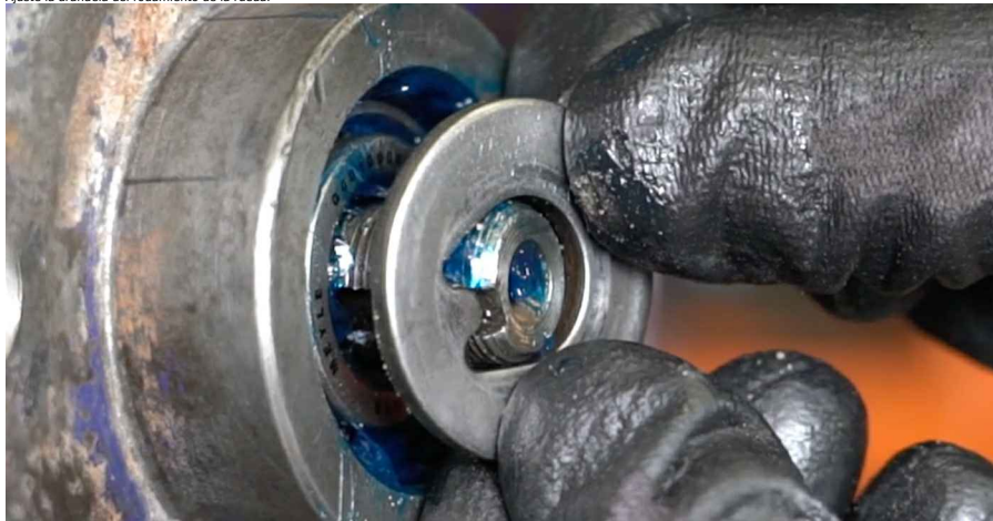
46 Atomille la tuerca del cubo. Use un vaso de impacto del n.º 24. Utilice una llave de trinquete.
