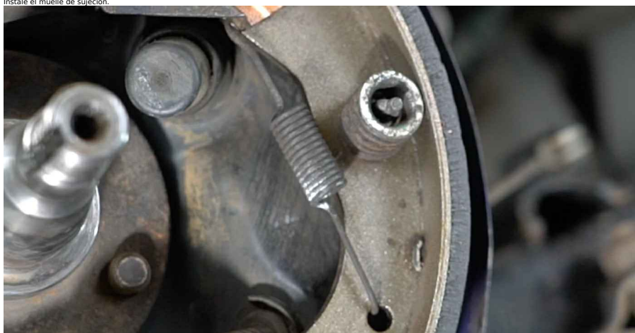
40 Instale el muelle de retorno superior. Utilice unos alicates de nariz larga.
