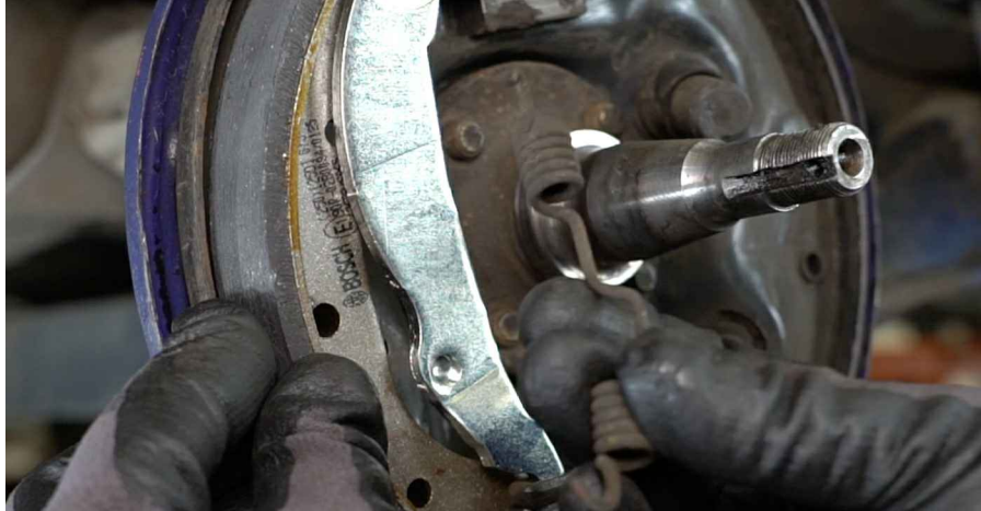
25 Instale el muelle de retorno inferior.
