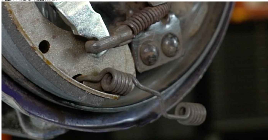
26 Retire el muelle superior y el ajustador.
