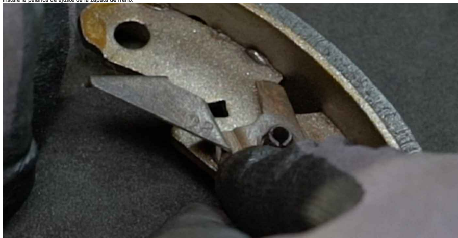
34 Instale el anillo de seguridad.
