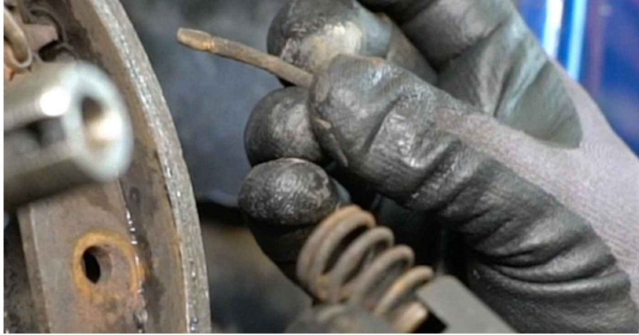
17 Retire la zapata de freno del muelle inferior.
