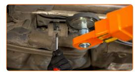
Apriete los clips y separe las líneas de suministro de combustible de la carcasa del filtro de aceite. Utilice alicates para conectores de tubos de combustible.
