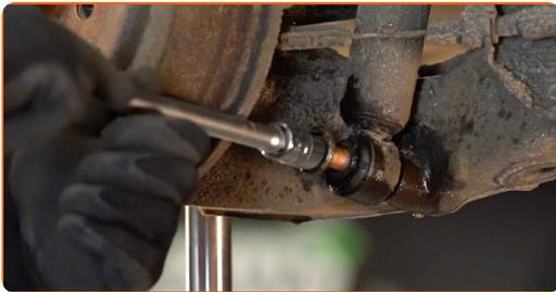
9 Retire el perno de sujeción.
