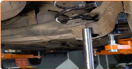
16 Apriete la fijación superior del amortiguador. Use un vaso de impacto del n.º E20. Utilice una llave dinamométrica. Apriételo a un par de 90 Nm.
