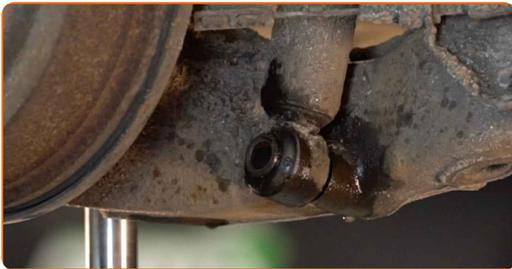
10 Destornille la fijación superior del amortiguador. Use un vaso de impacto del n.º E20. Utilice una llave giramachos.
