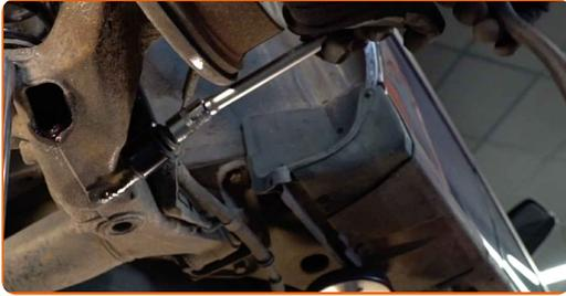
15 Eleve el gato hidráulico de transmisión en unos 10-15 cm. Utilice un gato de transmisión hidráulica.
