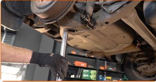
8 Destornille la fijación inferior del amortizador. Use un vaso de impacto del n.º E20. Utilice una llave giramachos.
