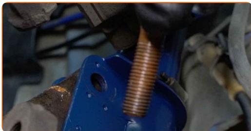
**37** Desconecte el muñón de dirección de la pata amortiguadora.
