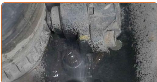
**33** Desenrosque la sujeción del sensor del ABS. Use Vaso HEX No. H5. Utilice una llave de trinquete.
