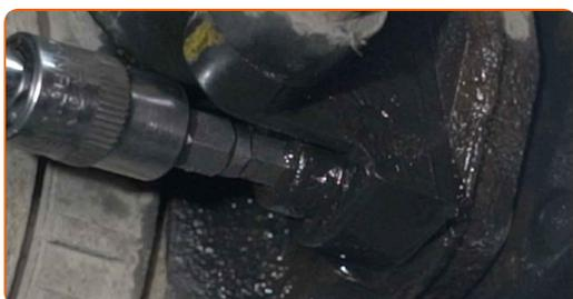
**34** Retire el perno de sujeción.
