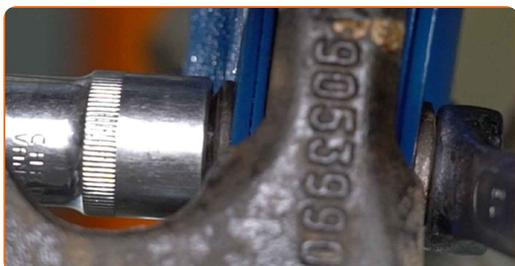
**71** Ajuste la arandela del rodamiento de la rueda.
