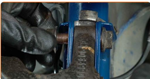
**64** Instale el perno de sujeción.
