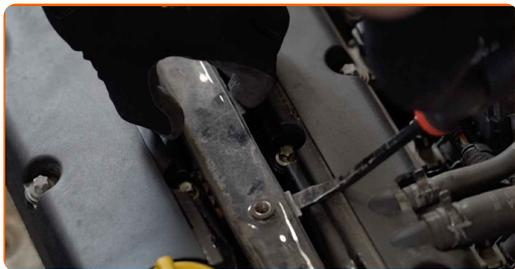
**6** Saque la bobina de ignición del pozo de la bujía.
