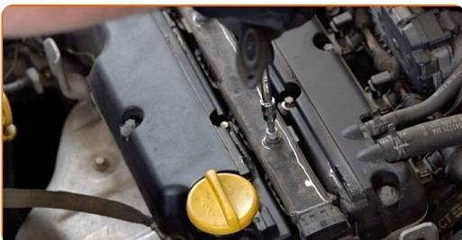
**5** Levante la bobina de ignición haciendo palanca. Use una palanca.
