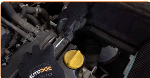
**4** Destornille la atadura de la bobina del encendido. Utilice Torx T30. Utilice una llave de trinquete.
