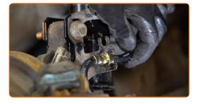
Instale la abrazadera de retención del latiguillo de freno. Utilice un mazo de goma.
