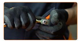
Limpie la suciedad del perno del latiguillo de freno. Use un limpiador de frenos.
