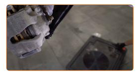
Desatornille la sujeción que conecta el latiguillo de freno al tubo del circuito del freno. Usa una llave mixta del n.º 10.
