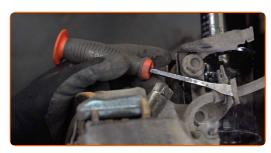
9 Separe el latiguillo de freno del puntal amortiguador.
