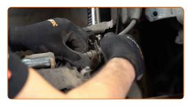
Coloque un recipiente por debajo para recoger el líquido de frenos.
