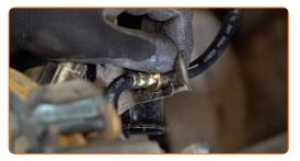
Conecte la manguera del kit de purgado de frenos al tornillo de purgado de freno.
