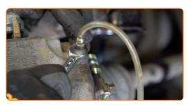
Presione varias veces el pedal de freno para retirar aire del sistema.
