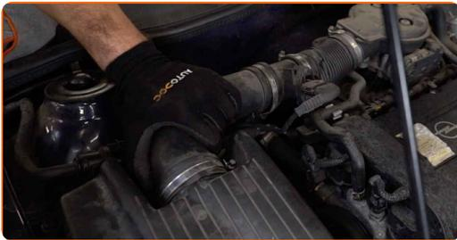
39 Fije la abrazadera en el manguito de admisión de aire. Use un vaso de impacto del n.º 7. Utilice una llave de trinquete.
