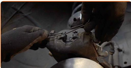
**19** Trate el soporte de la pinza de freno donde entra en contacto con las pastillas de freno. Use pasta antichirridos.
