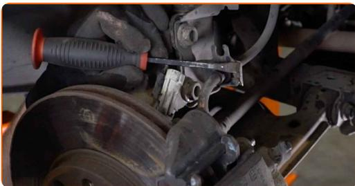
**11** Tire a un lado del muelle de retención de la pinza de freno. Use una palanca.
