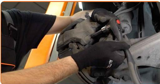
**10** Retire la sujeción que une el latiguillo de freno al puntal amortiguador. Use una palanca.
