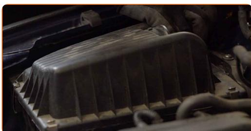
**36** Conecte las sujeciones que conectan el tubo de aire y el arnés del cableado a la carcasa del filtro de aire.
