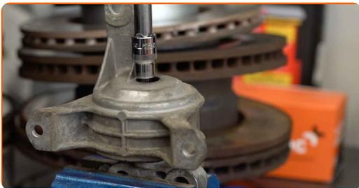
**20** Atornille el nuevo soporte del motor a la montura. Utilice Torx T55. Utilice una llave de trinquete.
