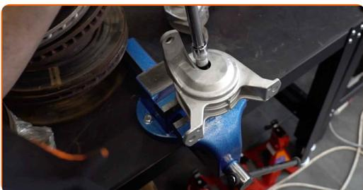
**21** Retire la montura con el soporte del motor de la mordaza.
