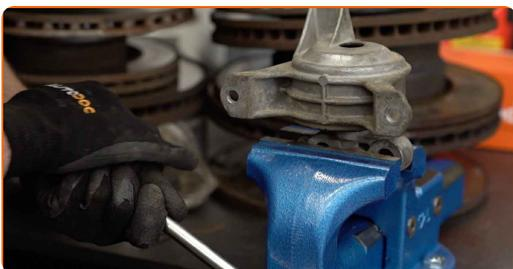
**19** Desatornille el soporte del motor de la montura. Utilice Torx T55. Utilice una llave de trinquete.
