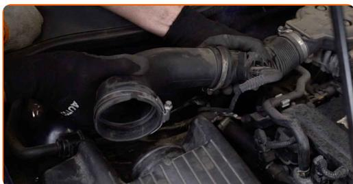
**38** Conecte el tubo de entrada de aire a la carcasa del filtro de aire.
