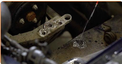
**23** Instale el soporte del motor en su asiento de montaje.
