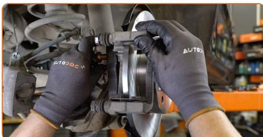
**24** Apriete la fijación de la pinza del cáliper de freno. Use un vaso de impacto del n.º E16. Utilice una llave dinamométrica. Apriételo a un par de 100 Nm.
