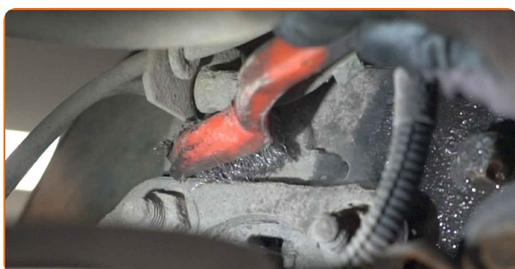
**8** Afloje la fijación del latiguillo de freno. Use un vaso de impacto del n.º E11. Utilice una llave de trinquete.
