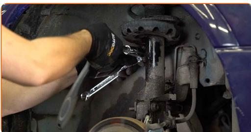
**8** Limpie las sujeciones de la bieleta o enlace estabilizador. Use un cepillo de alambre. Use el aerosol WD-40.
