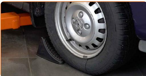
**4** Afloje los pernos de fijación de la rueda. Utilice una llave de impacto para llanta # 17.
