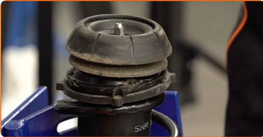
26 Apriete la tuerca de la varilla de la pata amortiguadora. Usa una llave mixta del n.º 19. Use un vaso de impacto del n.º 9. Utilice una llave dinamométrica. Apriételo a un par de 50 Nm.
