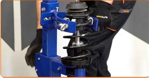
28 Retire el puntal amortiguador que está montado.
