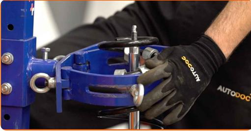
25 Instale el soporte, el fuelle y el tope en el amortiguador.
