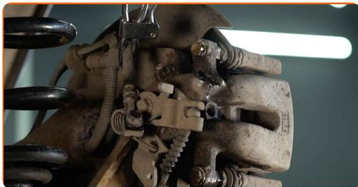
**12** Destornille la fijación del cáliper de freno. Usa una llave mixta del n.º 13.
