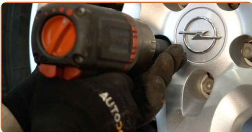
**48** Baje el automóvil y, manteniendo el orden cruzado, apriete los pernos de fijación de las ruedas. Utilice una llave dinamométrica. Apriételo a un par de 110 Nm.
