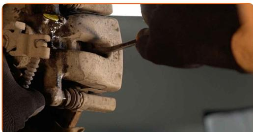
**14** Retire el soporte de freno. Use una palanca.
