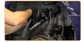
Desatornille la sujeción inferior que conecta el puntal amortiguador a la mangueta de dirección. Usa una llave mixta del n.º 18. Use un vaso de impacto del n.º 18. Utilice una llave giramachos.
