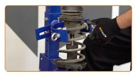
Destornille la tuerca de la varilla de la pata amortiguadora. Usa una llave mixta del n.º 19. Use un vaso de impacto del n.º 9.
