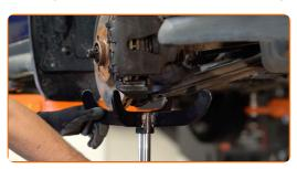
Retire la sujeción que une el latiguillo de freno al puntal amortiguador.
