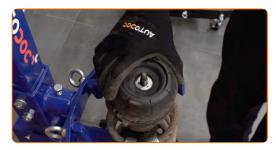
Instale la nueva montura, fuelle y tope del amortiguador.
