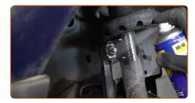
Destornille la tuerca y quite la barra del estabilizador desde la pata amortiguadora. Usa una llave mixta del n.º 19. Use un vaso de impacto del n.º 18. Utilice una llave de trinquete.
