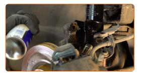
Fije la pata amortiguadora en el muñón de dirección.
