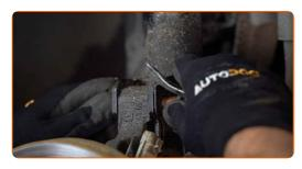
Desconecte la fijación de la manguera de freno de la conexión con la pata amortiguadora. Utilice un destornillador plano.
