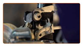
Fije el enlace estabilizador de el soporte de amortiguador. Usa una llave mixta del n.º 19. Use un vaso de impacto del n.º 18. Utilice una llave dinamométrica. Apriételo a un par de 65 Nm.
