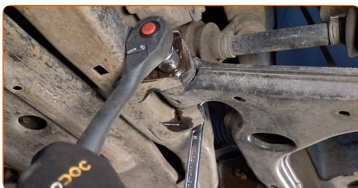
**11** Afloje la sujeción posterior del brazo de control. Use un vaso de impacto del n.º 18. Use una llave mixta del n.º 18. Utilice una llave de trinquete.
