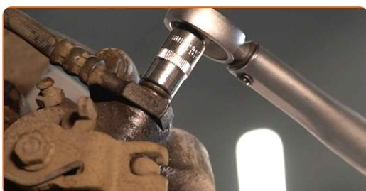
**26** Retire la abrazadera de la manguera del freno.
