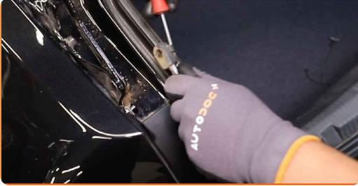
12 Limpie los asientos de montaje del resorte amortiguador del maletero. Use el aerosol WD-40.
