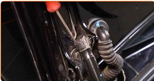
10 Libere el anillo de seguridad que conecta el amortiguador de gas a la carrocería del automóvil. Utilice un destornillador plano.
