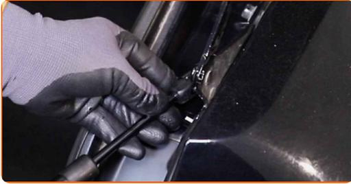
8 Haga encajar la arandela de ajuste que conecta el amortiguador de gas a la puerta del maletero.
