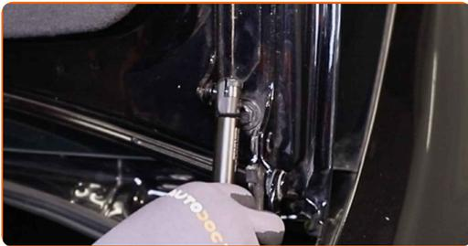
9 Libere el anillo de seguridad que conecta el amortiguador de gas a la puerta del maletero. Utilice un destornillador plano.
