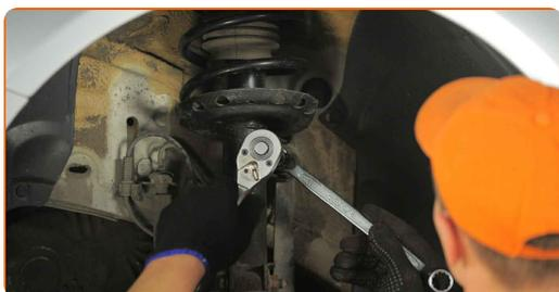
**47** Trate las sujeciones del amortiguador. Trate todas las juntas de la bieleta o enlace estabilizador. Use grasa de cobre.
