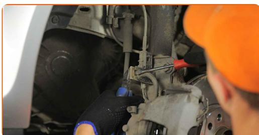
**7** Suelte el conector del sensor ABS. Utilice un destornillador plano.
