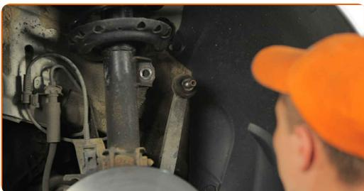
**11** Limpie las sujeciones que conectan el puntal amortiguador a la mangueta de dirección. Use un cepillo de alambre. Use el aerosol WD-40.
