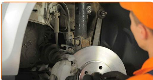
**41** Apriete las sujeciones inferiores que conectan el amortiguador con la mangueta de dirección. Use una llave mixta del n.º 18. Use un vaso de impacto del n.º 18. Utilice una llave dinamométrica. Apriételo a un par de 85 Nm.+90°
