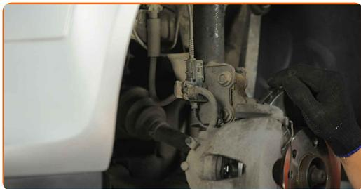
**45** Instale la barra del estabilizador de estabilidad transversal.
