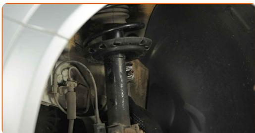
**46** Apriete la sujeción que conecta la bieleta de barra estabilizadora al amortiguador. Usa una llave mixta del n.º 19. Use Vaso HEX No. H5. Utilice una llave dinamométrica. Apriételo a un par de 60 Nm.
