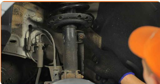
**9** Desatornille la sujeción que conecta la bieleta de barra estabilizadora al amortiguador. Usa una llave mixta del n.º 19. Use Vaso HEX No. H5. Utilice una llave de trinquete.
