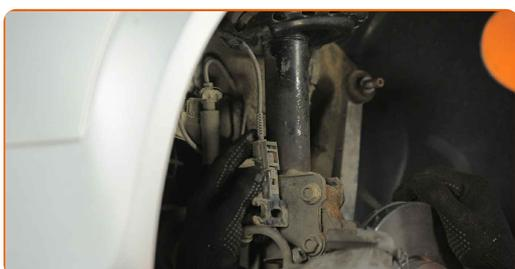
**43** En la pata fije el latiguillo del sistema de freno.
