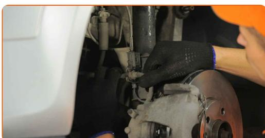
**44** Fije el clip de retención del latiguillo de freno. Utilice un mazo de goma.
