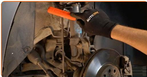
**14** Destornille la tuerca y quite la barra del estabilizador desde la pata amortiguadora. Use una llave mixta del n.º 19. Use un vaso de impacto del n.º 19. Utilice una llave de trinquete.
