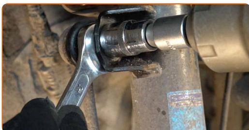
**15** Retire el enlace estabilizador de estabilidad transversal.
