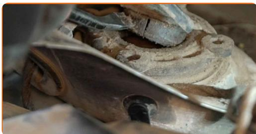
**6** Limpie las sujeciones del soporte superior del puntal amortiguador. Use un cepillo de alambre. Use el aerosol WD-40.
