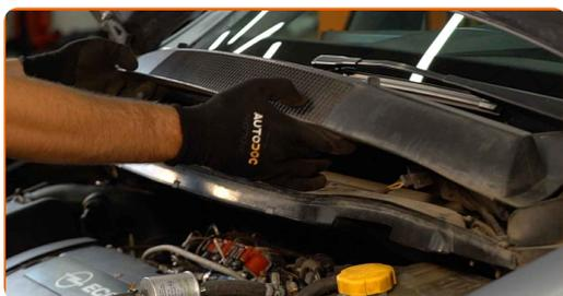
**5** Quite la tapa del soporte del amortiguador. Utilice un destornillador plano.
