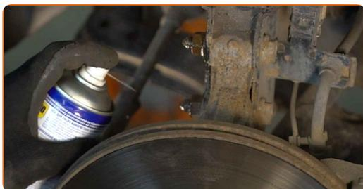
**17** Desatornille la sujeción inferior que conecta el puntal amortiguador a la mangueta de dirección. Use una llave mixta del n.º 18. Use un vaso de impacto del n.º 18. Utilice una llave giramachos.
