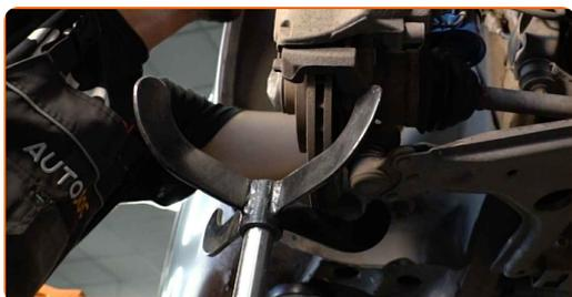
**48** Instale el retenedor del soporte del puntal superior del amortiguador. Use alicates de bomba de agua.
