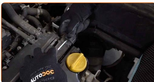
**4** Destornille la atadura de la bobina del encendido. Utilice Torx T30. Utilice una llave de trinquete.
