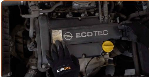
**3** Desconecte el conector de la bobina de ignición. Utilice un destornillador plano.
