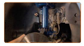
Apriete la sujeción que conecta la bieleta a la barra estabilizadora. Use un vaso de impacto del n.º 19. Utilice una llave dinamométrica. Apriételo a un par de 55 Nm.
