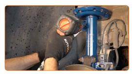
Retire el enlace estabilizador de estabilidad transversal.
