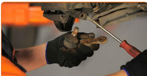
**14** Retire los pernos de sujeción (2 piezas). Utilice un destornillador plano.
