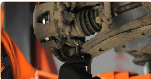
**8** Retire el perno de sujeción. Utilice un martillo.
