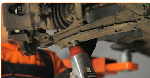
**20** Conecte el soporte esférico al muñón de dirección. Use una palanca. Utilice un mazo de goma.
