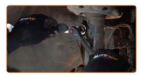
Desatornille la sujeción que conecta la bieleta de barra estabilizadora al amortiguador. Usa una llave mixta del n.º 18. Use un vaso de impacto del n.º 8. Utilice una llave de trinquete.
