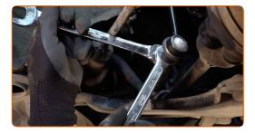
Apriete la sujeción que conecta la bieleta de barra estabilizadora al amortiguador. Use un vaso de impacto del n.º 19. Utilice una llave dinamométrica. Apriételo a un par de 60 Nm.
