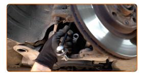
Apriete la sujeción que conecta la bieleta a la barra estabilizadora. Usa una llave mixta del n.º 17. Use un vaso de impacto del n.º 19. Utilice una llave dinamométrica. Apriételo a un par de 60 Nm.
